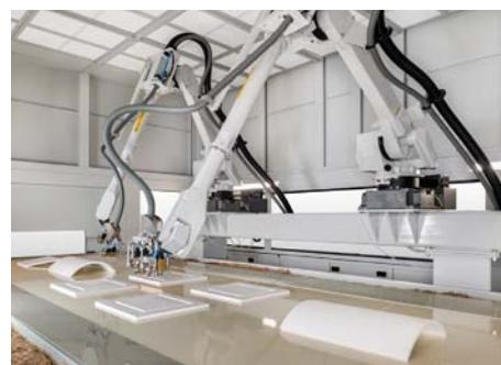
Работа роботов в камере окрашивания
