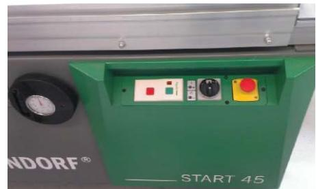
Пульт управления станком **Start 45** и маховик для наклона пил
