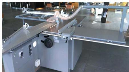
Вид станка сзади с маховиком для установки пил по высоте
