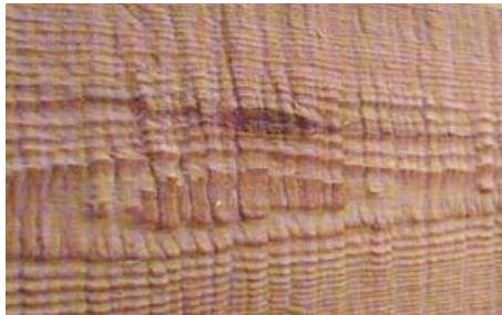
Поперечная обработка древесины
