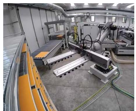
Работа робота на сортировке деталей
